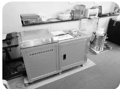
平成 26 年度に設置した非破壊式放射能測定装置
