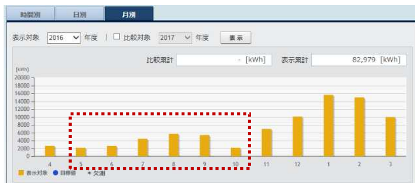
図表 梁川中学校の BEMS データ（動力設備消費電力量）
