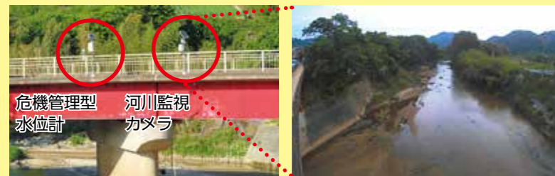
広瀬川（二村橋） 平常時の写真と現状を比較できる
