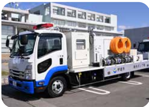
排水ポンプ車
