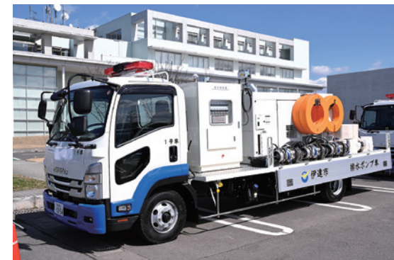
配備された排水ポンプ車
