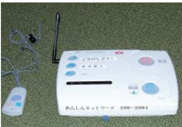
電話回線を活用した緊急通報装置
